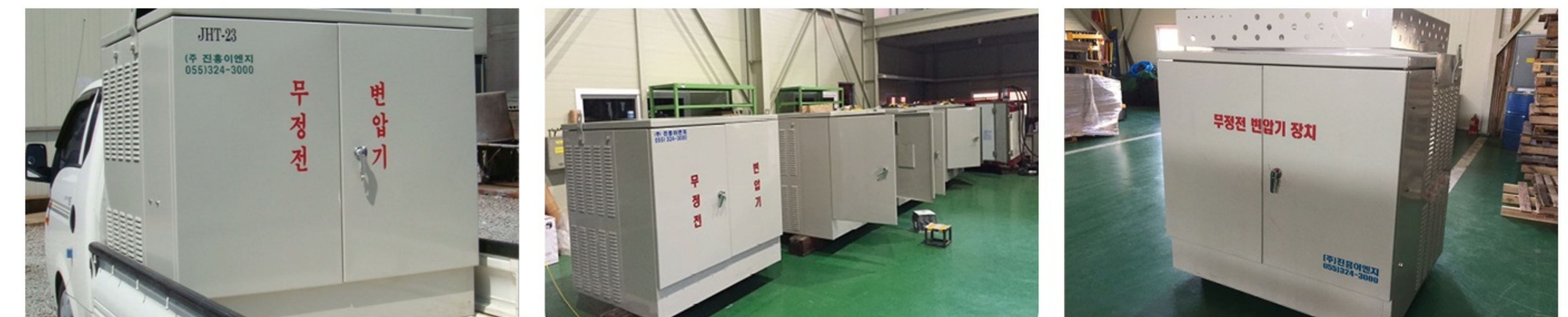
1.2Ton 작업차에 탑재한 3Φ300KVA TR장치
