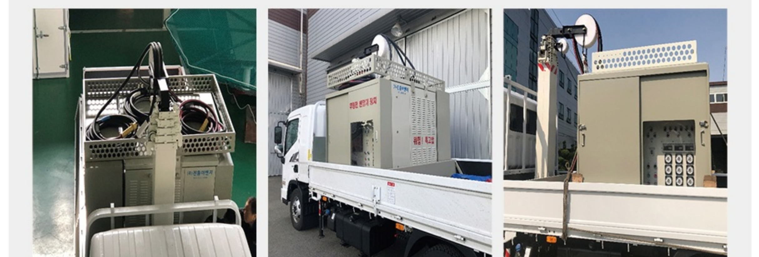
3.5Ton 트럭 탑재 변압기 장치 & 붐대리프트
