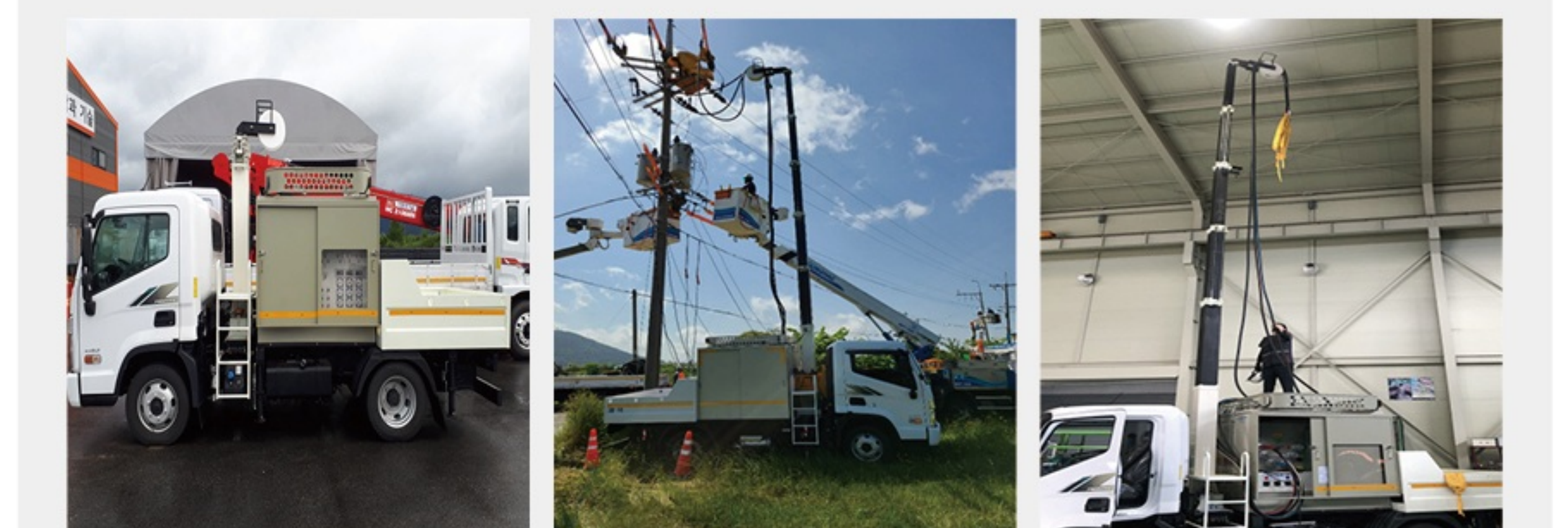
3.5Ton 사시캡 개조 & 변압기 붐대리프트 작업도
